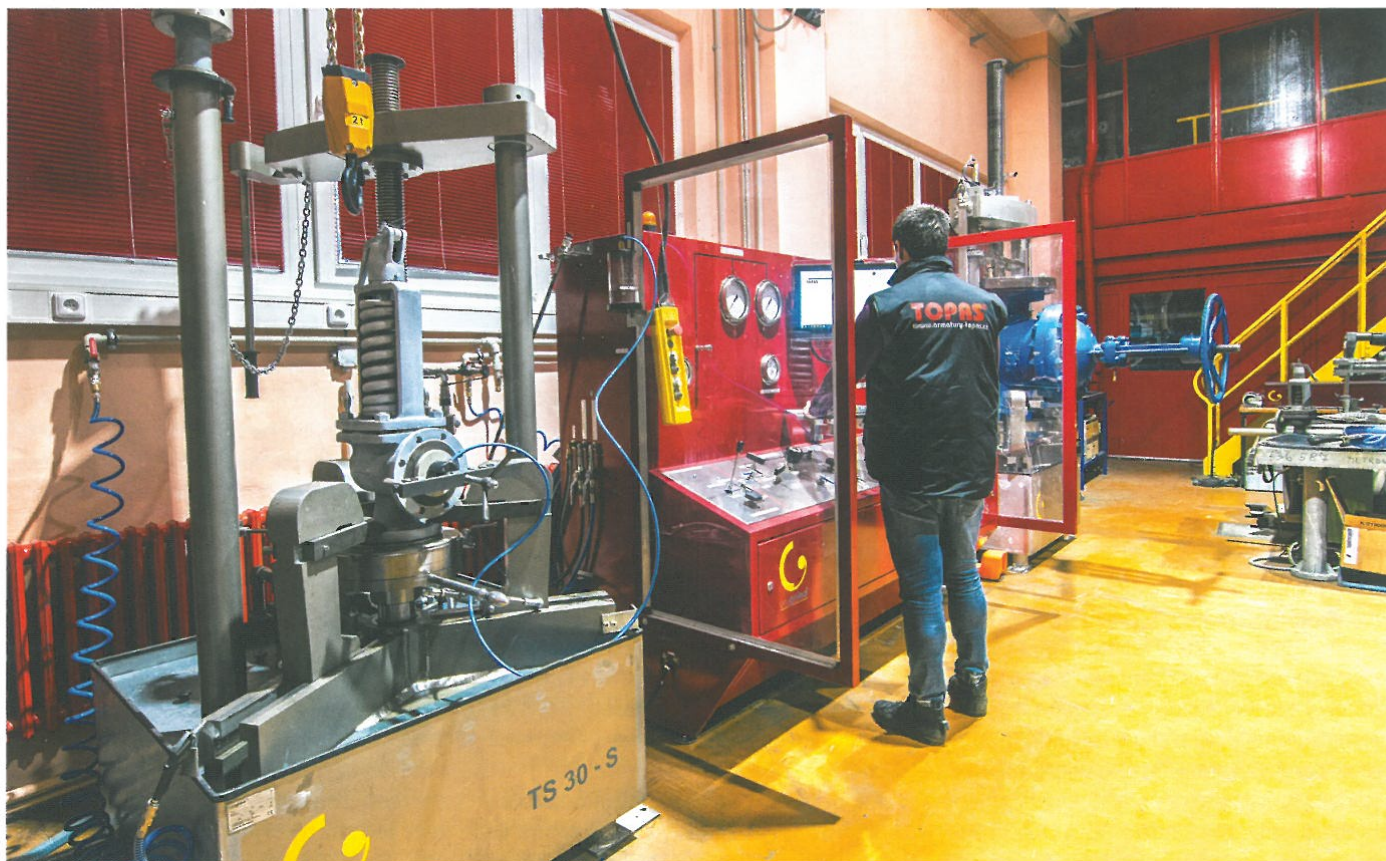
Zkušební stolice do DN650 a 350 bar.
