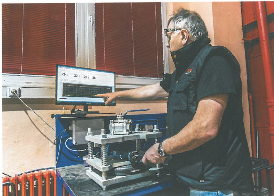
Zkušební stolice s grafem na uzavírací klapky.
